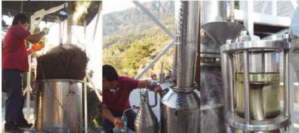
Şekil viii.9. Türkiye'de uçucu yağ elde etmek için lavanta damıtılması.
